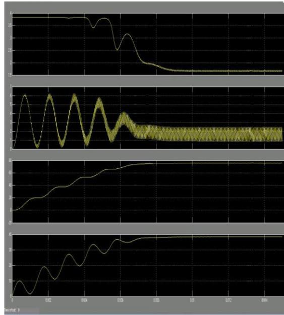
Figure4. i) Io Vs Time, ii) IL Vs Time, iii)Vo Vs Time, iv) V<sub>pv</sub> Vs Time
