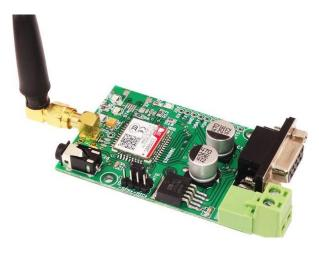
Fig. 6. GSM/GPRS SIM800C module
